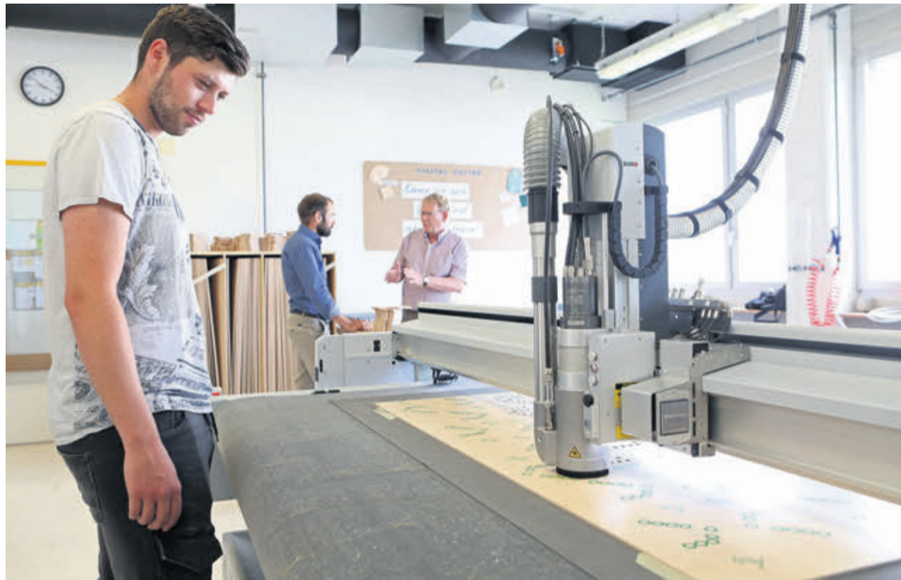
Der Digital Cutter wird im AWB Neuburgg in Sursee auch für die Produktion des Brändi Dog eingesetzt. FOTO ANA BIRCHLER-CRUZ
