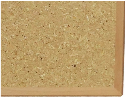
Tischplatte Spanplatte verdichtet
