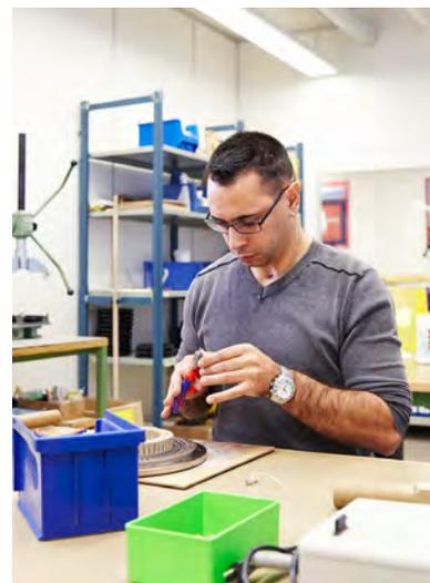
In der industriellen Montage werden hauptsächlich Grossserien verarbeitet. Dabei werden die Teile zu Baugruppen oder Fertigprodukten montiert. Die Ausführung der Arbeiten erfolgt manuell mit einfachen Werkzeugen, Vorrichtungen oder an Montageanlagen.
